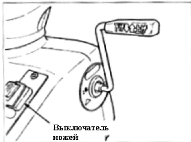
Нажмите на выключатель для включения режущего механизма (барабана).
