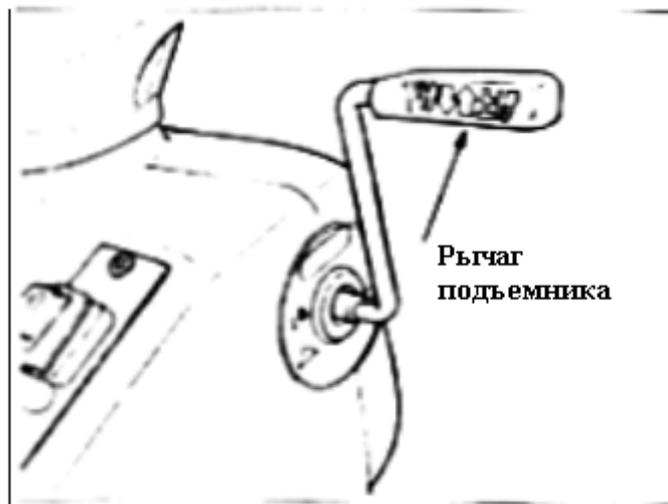
Подъем/опускание блока газонокосилки (деки).
